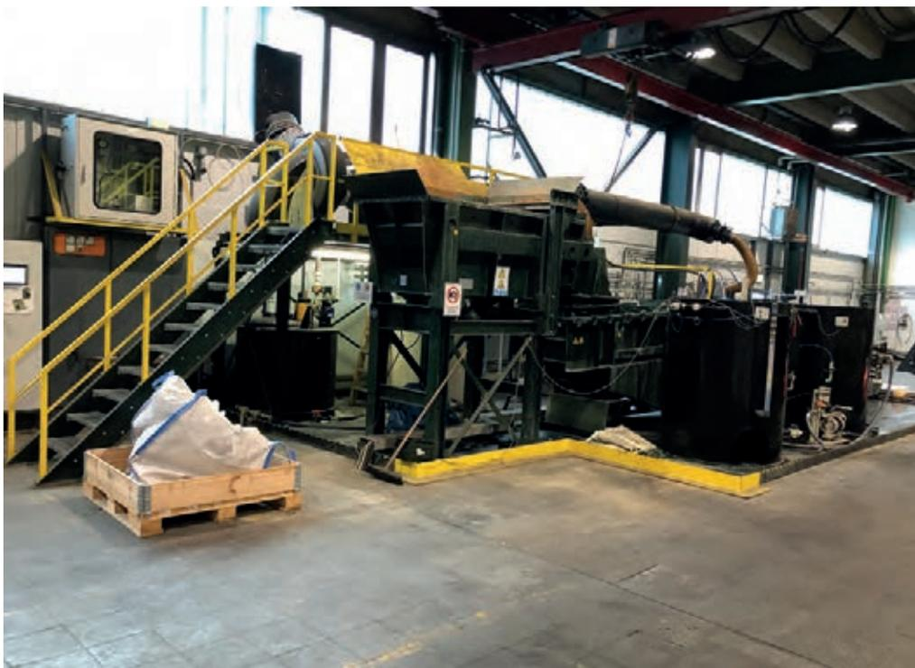
Prototyp einer Entzinkungsanlage. Schredder-Schrotte könnten hier entzinkt und damit zum Rohstoff für Komponenten aus Gusseisen mit Vermikular- sowie Lamellen-grafit werden.
