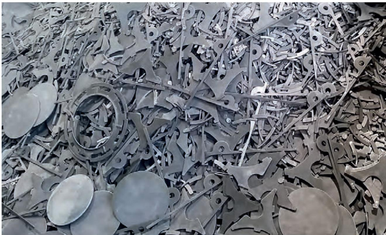
Die Hydrolyse – hier entzinkter Stanzschrott – ist ein mögliches Verfahren zum Veredeln von Stahlschrotten.
