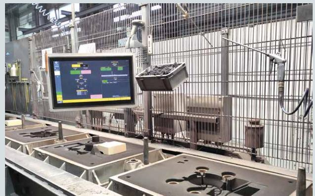
Panel zur Betriebsdatenerfassung an Formanlage – Pinter Guss
