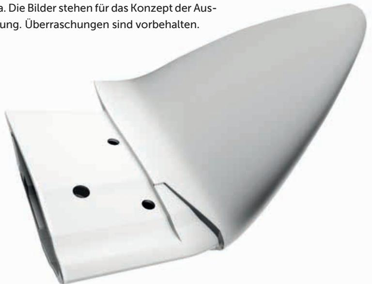
Ein weniger bekanntes, nicht ganz so großes Bauteil sitzt auf den Flügelspitzen der Windräder: die Blattspitze. Das innovative Gussprodukt reduziert die Reibungsverluste beim Strömungsabriss und leitet Blitzeinschläge ab. Es wird im Schwerkraft-Kokillenguss mit Sandkern hergestellt und stellt hohe Anforderungen an die Prüfungen am Gussteil und die Oberflächenqualität. Auch eine Blattspitze wird auf der Castainability zu sehen sein.
