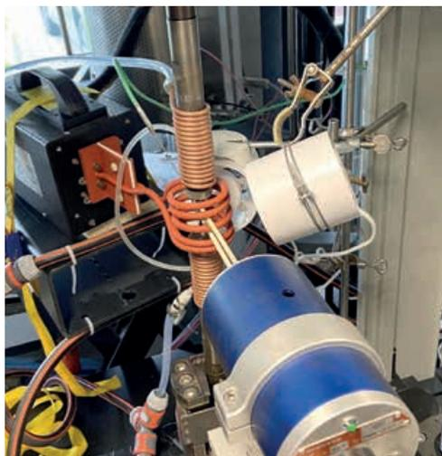
Die Bilder zeigen den Aufbau für den Thermo Mechanical Fatigue Test (TMF).
