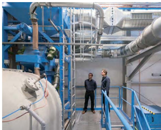
Bild 1: Geschäftsführer Ulrich Grunewald (links) und Gießereileiter Harald Dieckhues (rechts) an der thermischen Regenerierung, wo die schadstoffhaltige Luft über zahlreiche Absaugstellen zur Filteranlage geführt wird.
