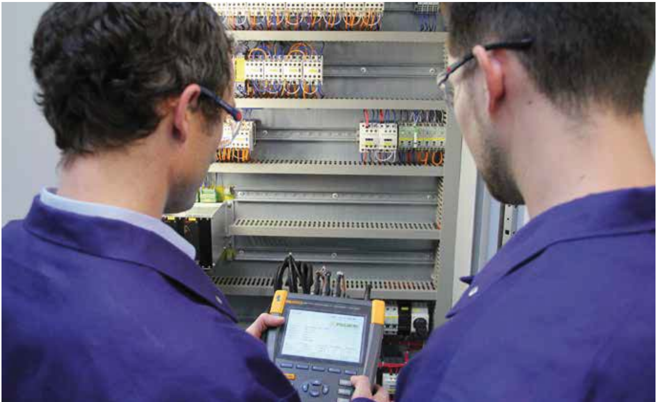
Bühler-Mitarbeiter während der Energiemessung an einer Druckgießanlage.
