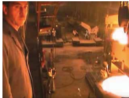
Innerhalb von 100 s wird die Form mit 120 t Flüssigisen gefüllt.
