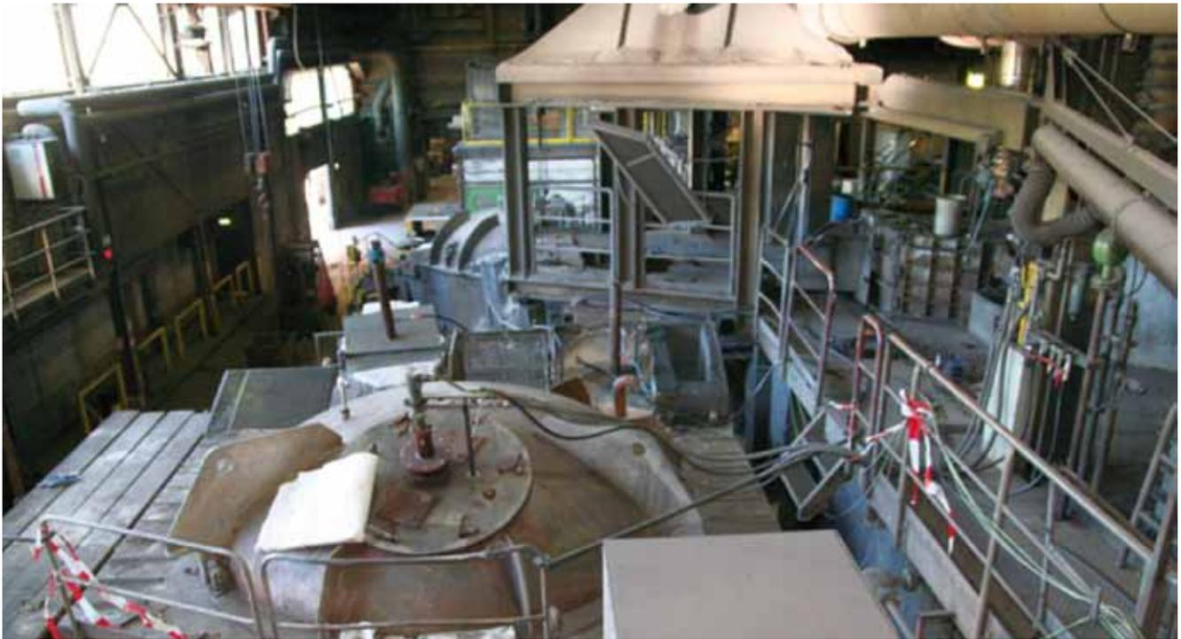
Bild 6: Einsatz eines Oxy-Fuel-Brenners für das Sintern und Aufheizen von Warmhalteöfen.
