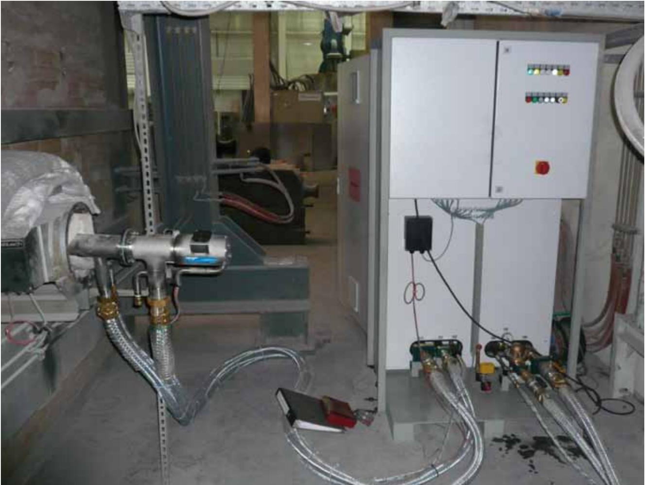
**Bild 5:** Aufheizprozess einer liegenden Pfanne: Der Brenner ist in der Wand befestigt (links); hinter der Wand befindet sich die Pfanne.
