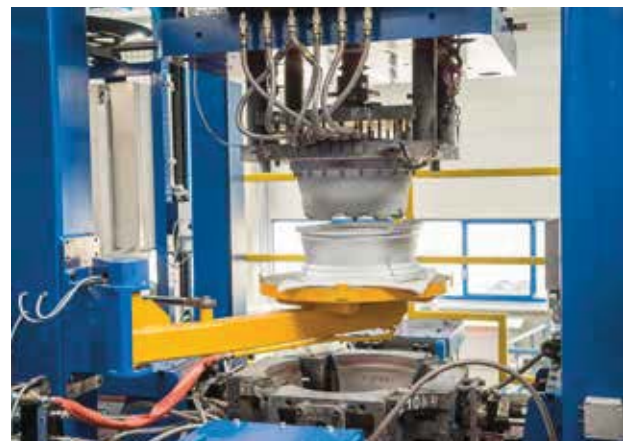
Bild 3: Im Niederdruckgießverfahren wird flüssiges Aluminium gleichmäßig und verwirbelungsfrei mit Überdruck unter Zuhilfenahme von Druckluft in eine Gussform gedrückt.
