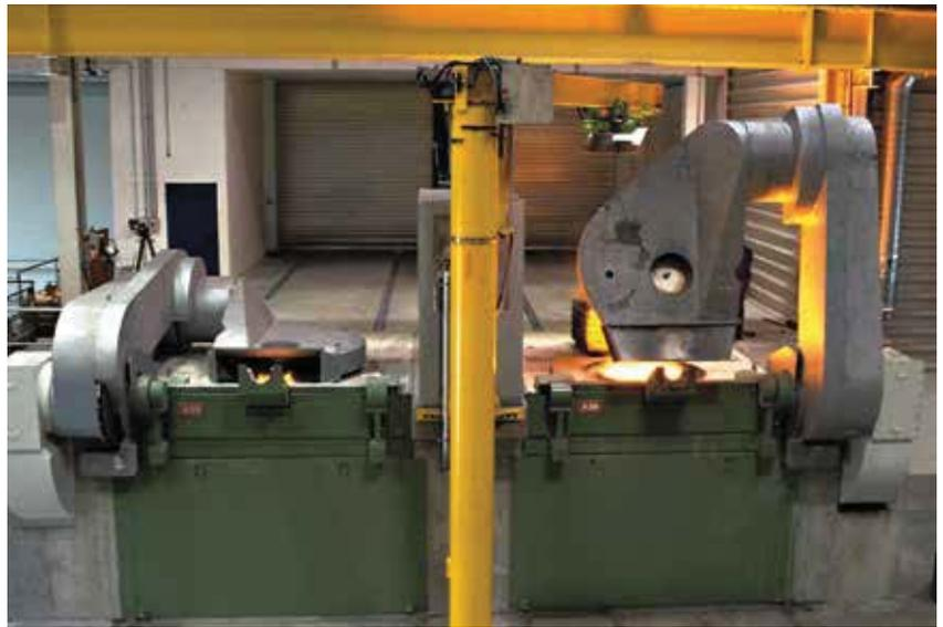
**Bild 9:** MF-Tiegelofen-Tandem, bestehend aus zwei 12-t-Öfen mit einer 8400-kW-Twin-Power-Energieversorgung [7].
