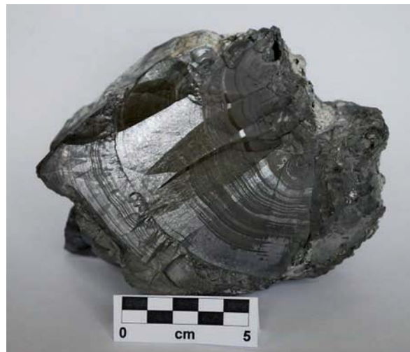
Bild 3: Das Projekt befasst sich auch mit der Schmelzequalität. So wird etwa die Entstehung von Korund bei bestimmten Prozessparametern untersucht.
