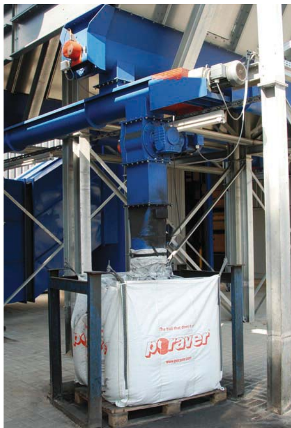
Bild 1: Über das Austragsystem kann das ausgefilterte Material in Big Bags verpackt oder dem Prozess wieder zugeführt werden.
