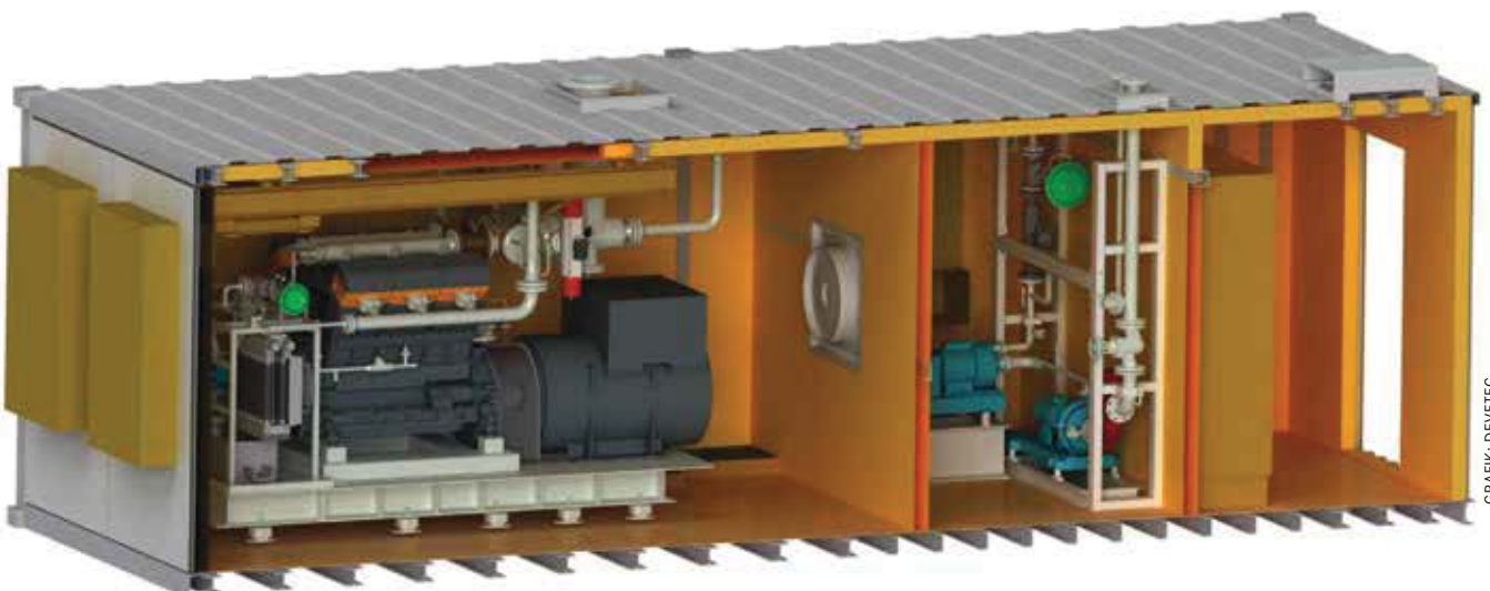
Bild 1: Schnitt durch eine mobile Containereinheit mit Expander-Generator-Einheit, Pumpeneinheit und Steuerungseinheit.
