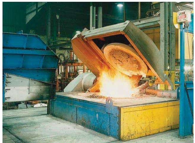
**Bild 8: Absaughaube mit integriertem Deckel für das Andocken der bereitstehenden Chargiereinrichtung (Quelle: ABP).**
