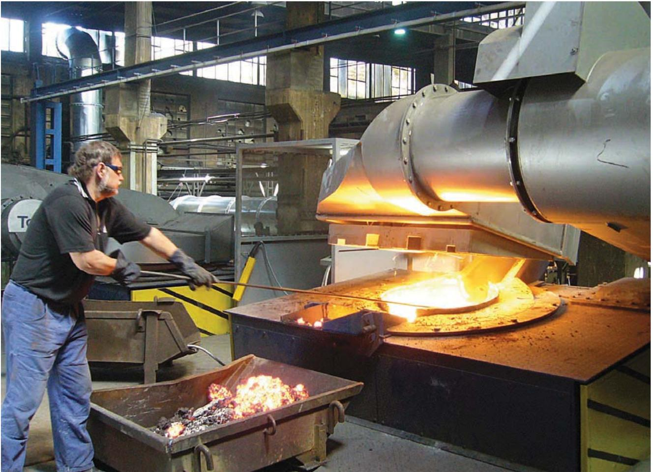
Bild 10: Abschlacken eines rückwärts gekippten 6 t-ABP-Tiegelofens.
