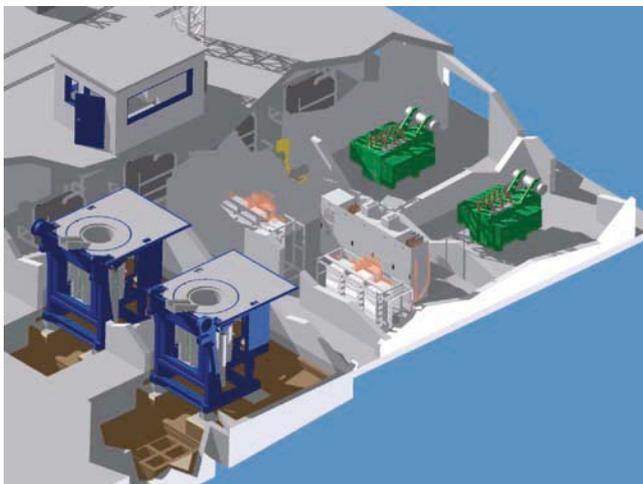
**Bild 7: Modell des Aufbaus einer MF-Tiegelofenanlage (Quelle: ABP).**
