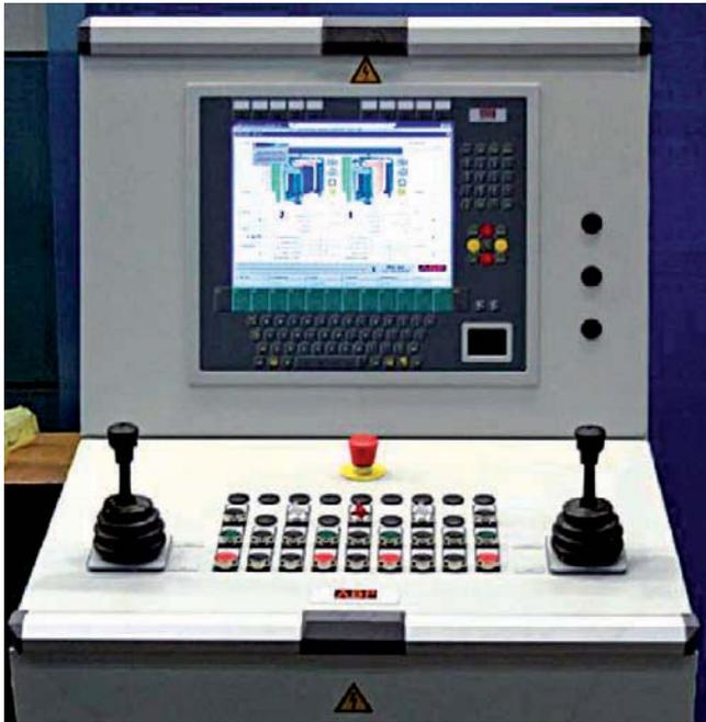
Bild 11: Bedienpult mit ABP-Prodapt-Bildschirm einer Tandemanlage.
