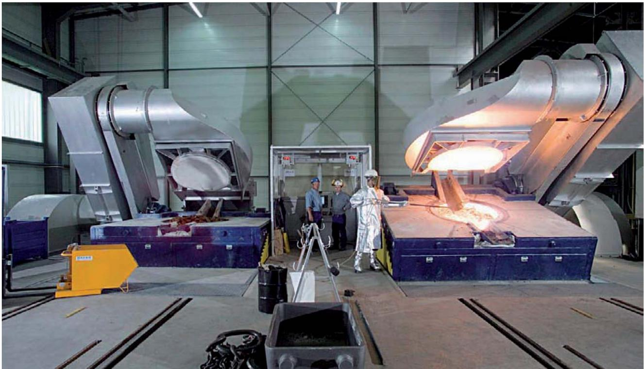
Bild 13: Tandem-Schmelzanlage mit variabler Leistungsaufteilung (Quelle: ABP).
