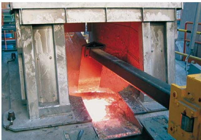
Bild 16: Mechanisiertes Abkrätzen der Messingschmelze in einem 30 t-ABP-Tiegelofen.
