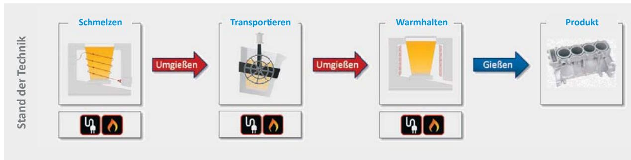
**Bild 3:** IST-Stand der Prozessgestaltung in der KMU-Leichtmetallgusserzeugung.
