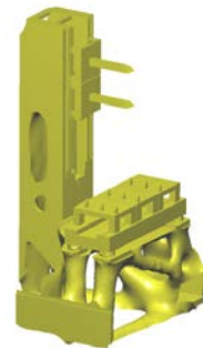
Abbildung 1: Maschinenbett mit angegossenem Ständer. Das Maschinenbett wird in einer Werkzeugnachscharf-Maschine verwendet.
