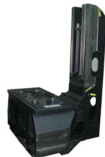
Abbildung 2: In wirtschaftliche Gusskonstruktion umgesetzter Gestaltungsvorschlag
