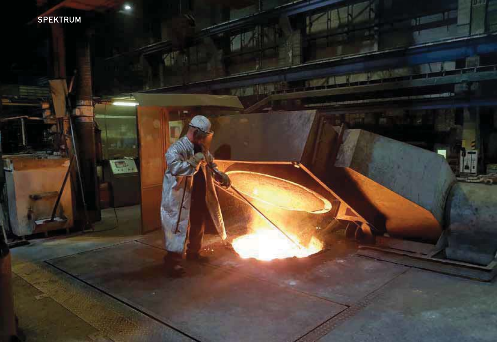
Modernisierter Netzfrequenztiegelofen bei Koenig & Bauer in Würzburg.
