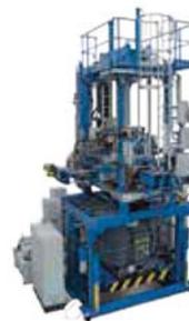
Niederdruckgießmaschine für Motorblöcke
