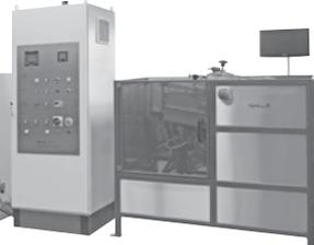
**Induktive Umschmelzanlagen für metallische Proben.** Lifumat-M-3.3 P (Vac). Emission, AAS, ICP, X-Emission. **Neu:** Steuerung über Touchscreen und Programmspeicher für höchsten Bedienkomfort.
