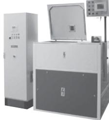
**Induktions-beheizte Zentrifugalgießmaschinen** für Präzisions- für Ti/TiAl, 3 kg Stahl, 1 kg Al/Mg, 3 kg Superlegierungen.
