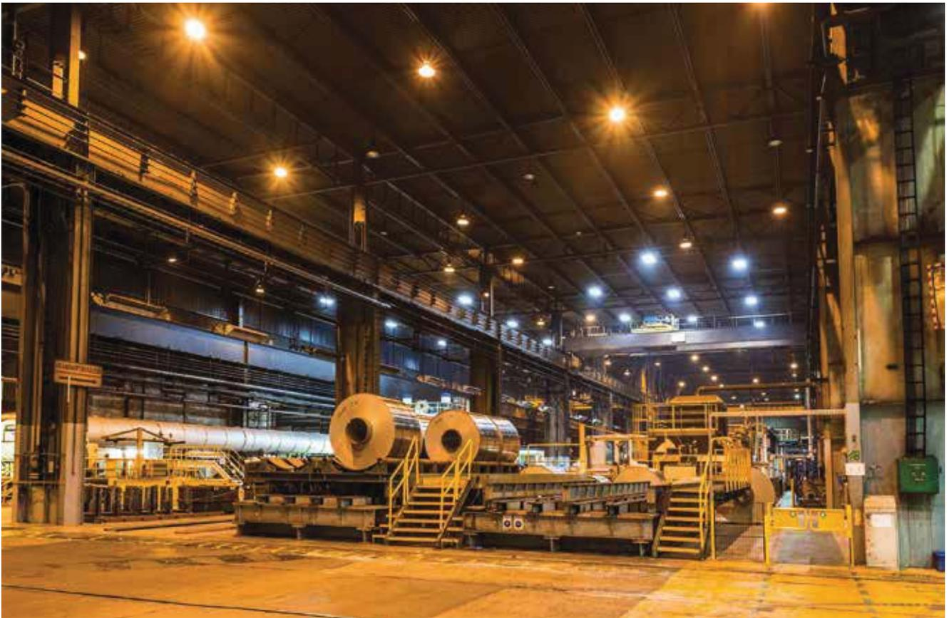
**Bild 5:** LED-Industrieleuchten – robust, spritzwasserfest, staubdicht, mit hoher Wärmetoleranz [41].
