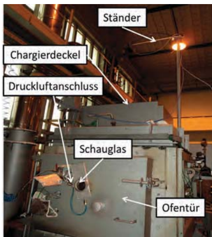
Bild 3: Das am IFUM in Hannover ausgewählte Kamerasystem für das Vermessen der Höhenänderungen im Aluminiumofen wurde im Rahmen von Versuchen an der TU in Freiberg erprobt. Hierzu wurde zunächst die optimale Kameraposition über dem Chargierdeckel des Ofens ermittelt, in der die Kamera anschließend fest positioniert wurde.
