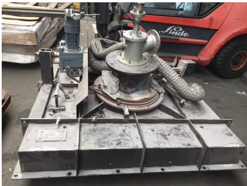
Bild 4: Um den Gasbrenner exakt auf das Schmelzgut ausrichten zu können, wurde bei ZPF ein Demonstrator mit dynamischem Brennersystem entwickelt, der die Position des Schmelzgutes mit Hilfe eines Überwachungssystems detektiert.
