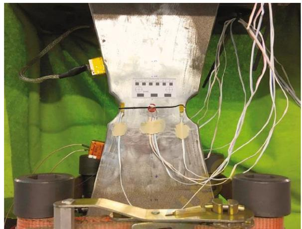
Bild 2: Gekerbte Großbauteilprobe (1700 mm x 100 mm x 100 mm) mit künstlich eingebrachten Fehlern und Messtechnik im Ermüdungsversuch
