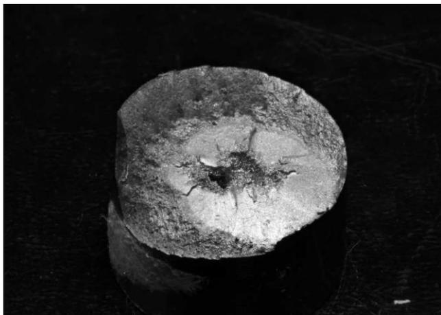
Bild 1: Von einem innenliegenden Erstarrungslunker ausgehender Ermüdungsriss
