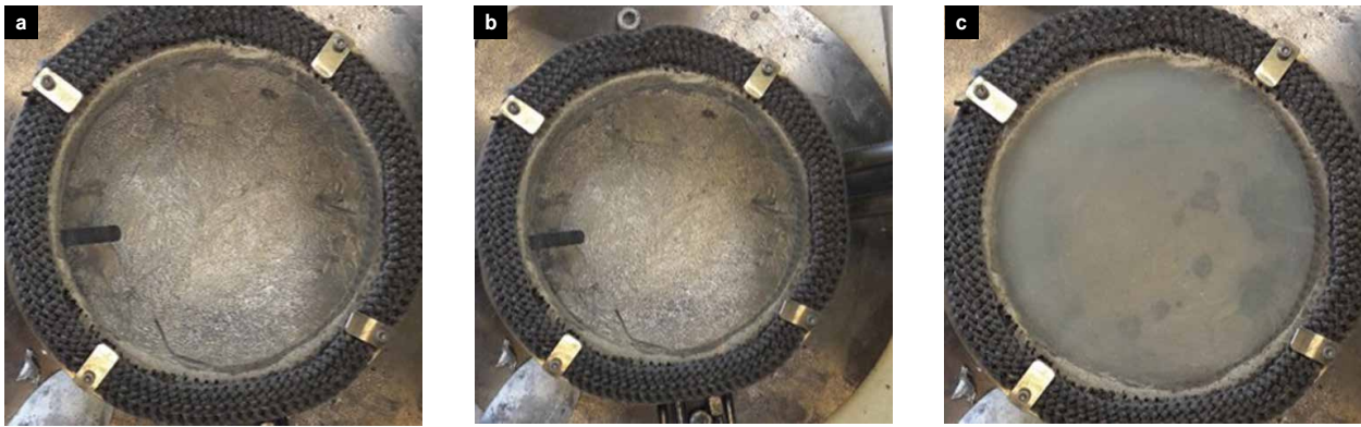
Tiegelatmosphäre bei Reduzierung der Schutzgasmenge AZ91D, 630°C mit Messgasrückführung
