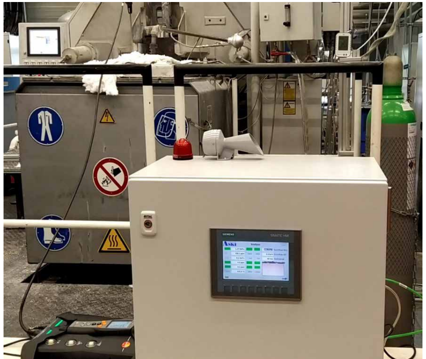
Bild 8: Prototyp des entwickelten Magnesium-Schutzgasregelsystems mit angeschlossenem Gasanalysegerät Testo-350 während des Schmelzbetriebs an einem Magnesium-Schmelzofen einer Frech-Warmkammer DAM-500F.
