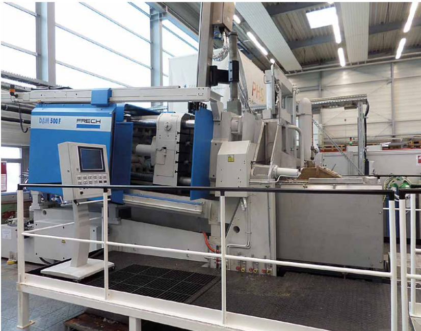
Bild 5: Warmkammer-Druckgießzelle Frech-DAM-500F, Gießerei-Technikum (GTK), Kassel.
