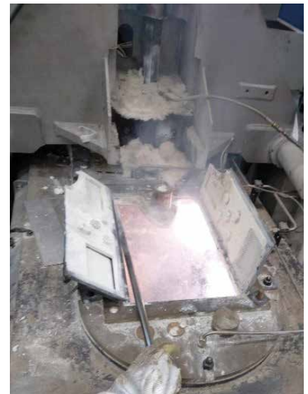
Bild 2: Beginnender Magnesiumbrand aufgrund einer nicht bemerkten fehlerhaften Schutzgaszufuhr.
