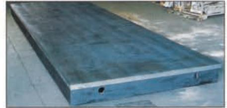
**Bild 52: Meßplatte aus GJL-250 mit Lochraster, Abmessungen: 7000 × 2250 × 300 mm, Gewicht: 10,3 t**
