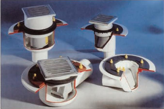
Bodenabläufe (teilgeschnitten) DN 70 und DN 100 mit Preßdichtungsflansch und herausnehmbarem Geruchverschluss, vollständig aus GJL-200 bestehend
