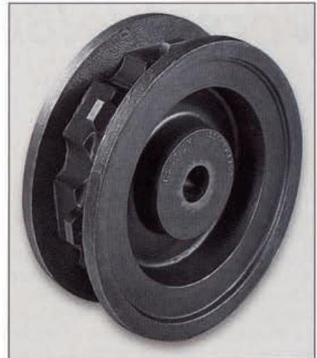
**Bild 93 Kettennuß für einen Kettenförderer, Werkstoff: GJL-300, Gewicht: 121 kg**
