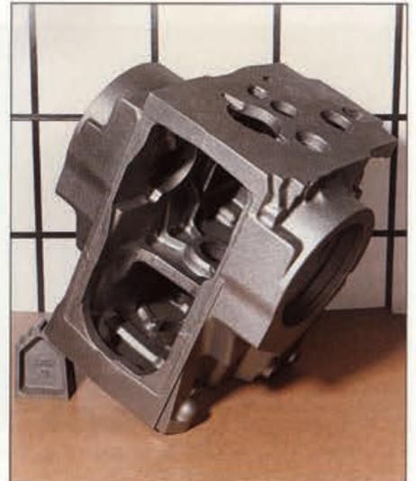
► Schaltgehäuse (geschnitten) für den Filterbau; Werkstoff: GJL-250, Gewicht: 157 kg
