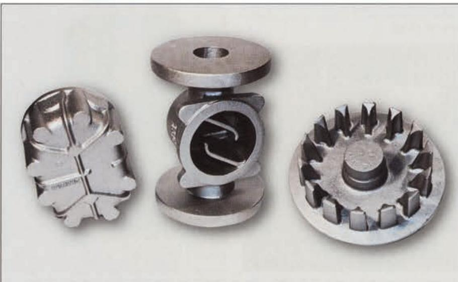
Armaturenbauteile aus GJL-200 und -250 mit Stückgewichten von 4,5 bis 8,3 kg
