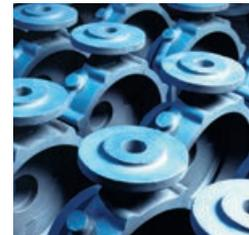
Gehäuseteile für Pumpen, Verdichter und Motoren sind wegen der guten Gießeigenschaften ein Haupteinsatzgebiet von GJL-Teilen
