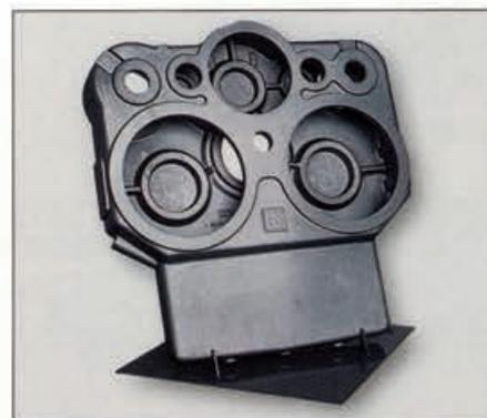
Bild 77: Getriebegehäuse aus GJL-250 für einen Bagger; Abmessungen: 1400 × 1400 × 400 mm, Gewicht: 705 kg
