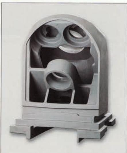
Spindelstock aus GJL-300 für eine Fräsmaschine, Gewicht: 488 kg
