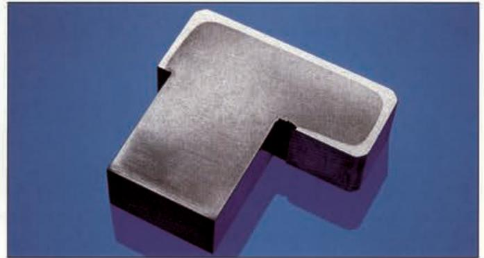
**Bild 118:** Werkzeugmaschinenbett aus GJL-300 mit induktiv gehärteten und geschliffenen Führungsbahnen, Abmessungen: 2410 × 840 × 980 mm, Gewicht: 2450 kg; unten: gleichmäßige Einhärtetiefe von etwa 3 mm,  $54 \pm 3$  HRC
