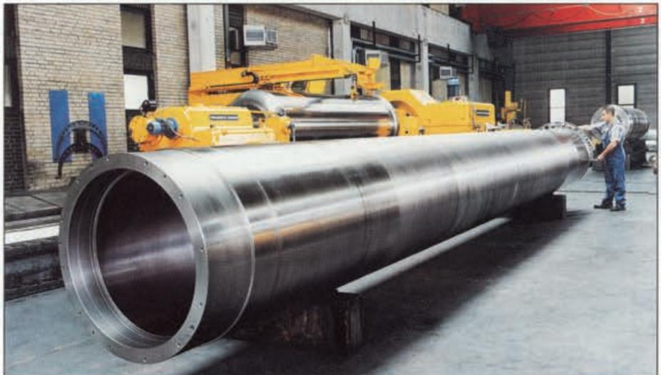
Biegeausgleichsmantel aus GJL-250 für das Glättwerk einer Papiermaschine; Abmessungen:  $\text{\O} 980/790 \times 9510$  mm, Gewicht: 17,9 t
