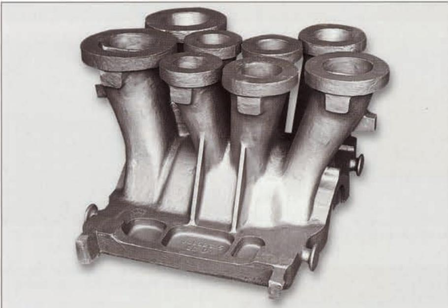
Gehäuse für einen Verdichter, Werkstoff: GJL-350, Gewicht: 3,75 t
