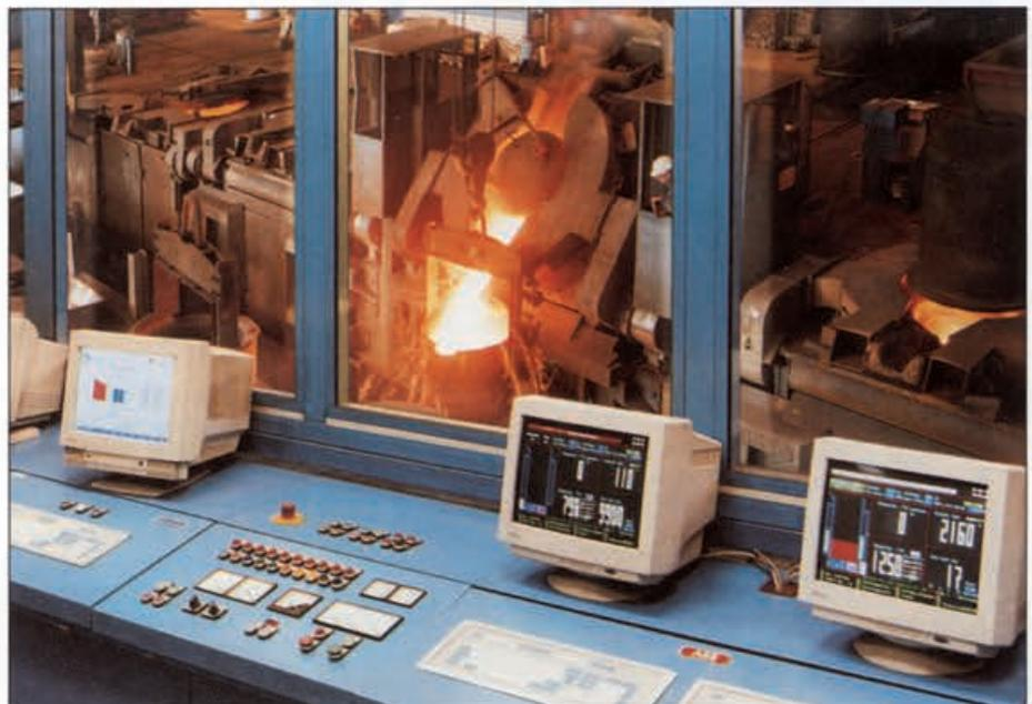
Bild 5: Steuer- und Leitstand einer Elektroschmelzanlage, im Hintergrund der Abstich eines Ofens
