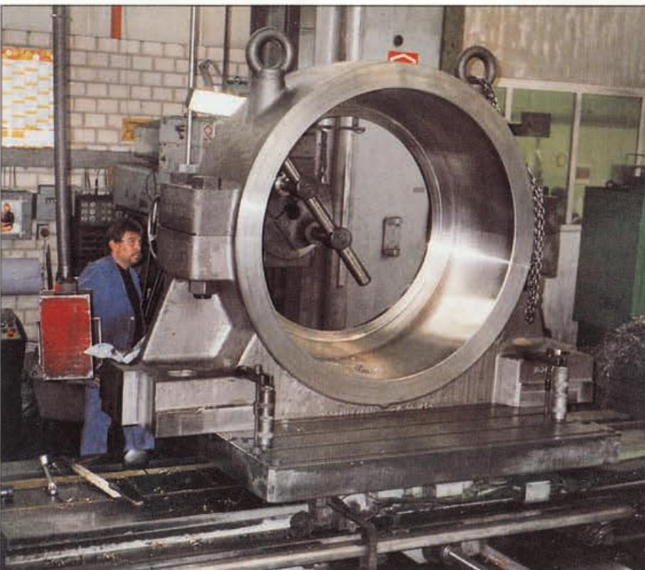
◀ Lagergehäuse (Konverter) für ein Wälzlager; Werkstoff: GJL-350, Gewicht: 10,4 t
