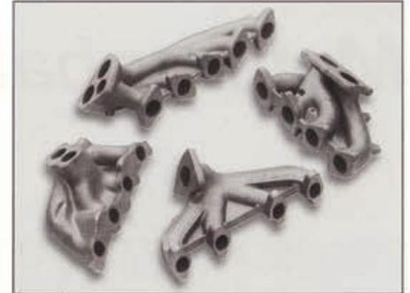
Die verschiedenen Gußeisenwerkstoffe sind ideal geeignet zum Herstellen von Kfz.-Abgaskrümmern.
