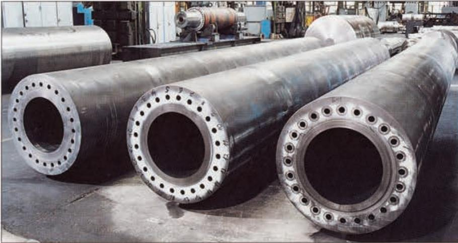
Bearbeitete und mit peripheren Bohrungen versehene Walzen für einen Papierkalandrier; Werkstoff: GJL-250, Abmessungen:  $\varnothing 850/475 \times 9300$  mm, Gewicht: 19,4 t
