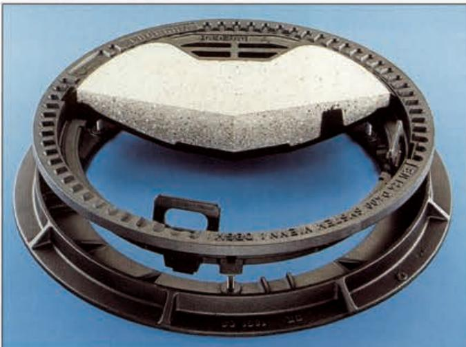
Dreiteilige Straßenschachtabdeckung aus GJL-250, Deckel mit Beton ausgegossen
