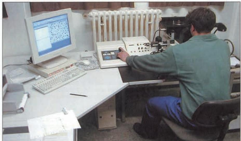
Bild 23: Anlage zur computergestützten quantitativen Gefügeanalyse
