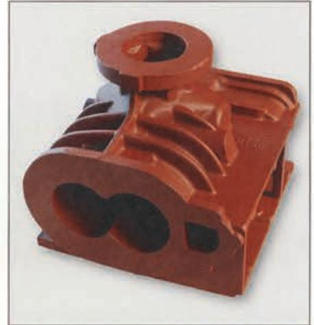
Gehäuse aus GJL-250 für einen Schraubenverdichter; Abmessungen: 420 × 345 × 430 mm, Gewicht: 136 kg
