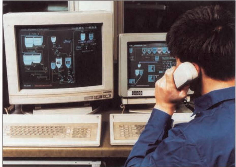
**Bild 12: Steuerwarte einer Sandaufbereitungsanlage**
