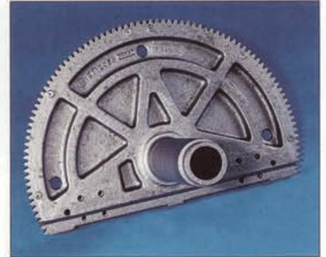
Steuersegment aus GJL-300 mit fertiggegossenen Zähnen für eine landwirtschaftliche Maschine, Gewicht: 22 kg
