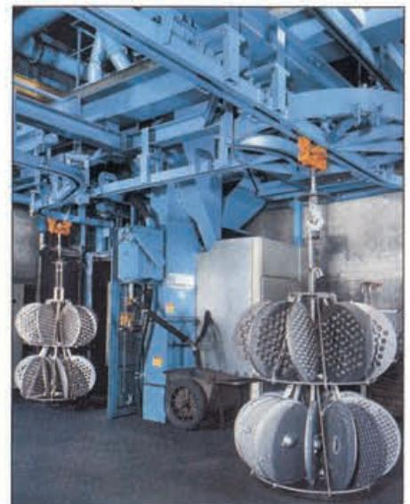
Bild 11: Hängebahnsystem für das Strahlputzen des Rohgusses
