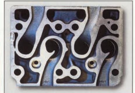
Querschnitt eines Dieselmotor-Zylinderkopfes aus GJL-300; die die Gas-, Wasser- und Ölkanäle trennenden Wände haben eine Dicke von nur wenigen Millimetern.
