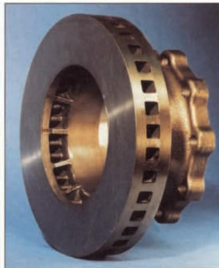
**Bild 13: Belüftete Lkw/Omnibusbrems-scheibe aus hochgekohltem, CuCr-legiertem GJL-150**
