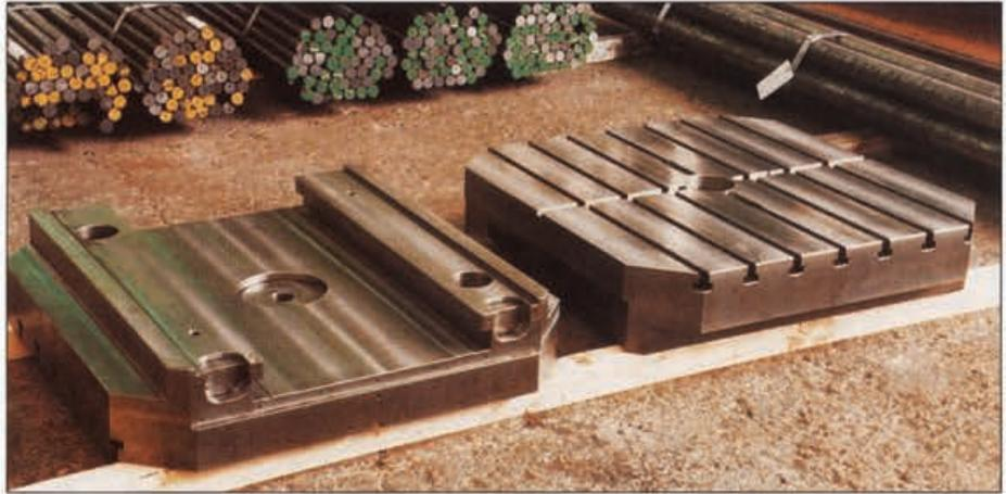
Palettentische für ein Bearbeitungszentrum; Werkstoff GJL-350, Abmessungen:  $1200 \times 1200$  mm
