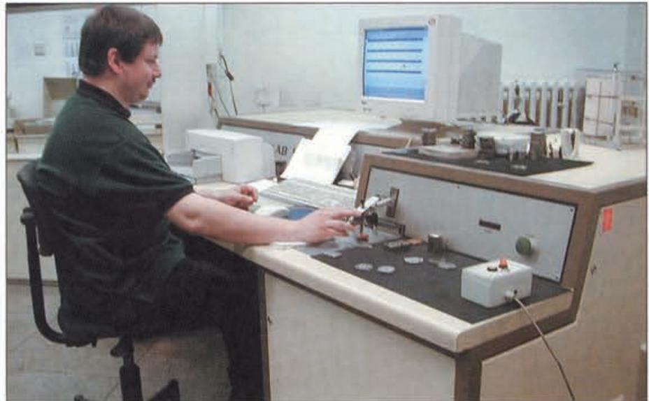
Bild 22: Optisches Emissionsspektrometer
