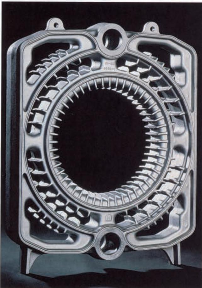
**Bild 3:** Komplizierte geometrische Form, geringe Wanddicke, hohe Maßgenauigkeit und korrosionsbeständig gegenüber aufbereiteten und nicht aufbereiteten Wässern sowie den heißen Feuerungsgasen sind Attribute dieses Heizkesselgliedes, realisiert mit Gußeisen mit Lamellengraphit
