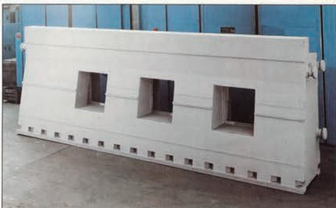
Seitenwandständer aus GJL-250 für eine Hochgeschwindigkeits-Fräsmaschine; Abmessungen: 1900 × 800 × 850 mm, Gewicht: 3,5 t
