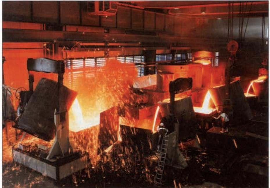
Bild 4: Gleichzeitiger Abguß eines Großwerkstücks aus fünf Pfannen
