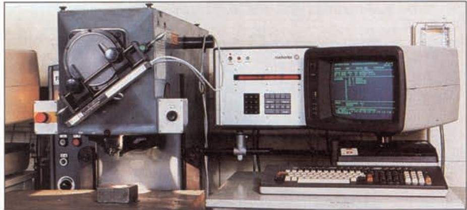
Bild 26: Computergestützte Härteprüfung mit EDV-Terminal und Monitor
