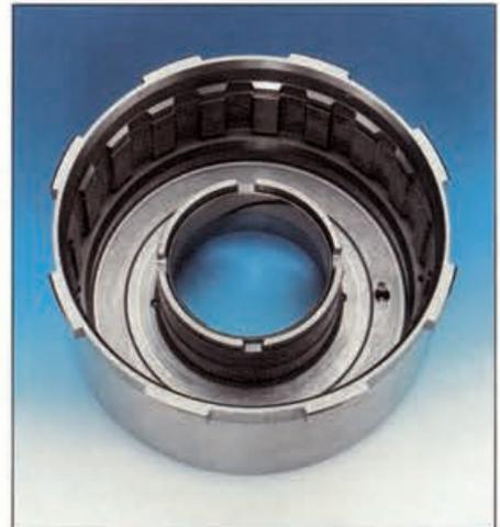
Fertigbearbeitete Getriebetrommel aus GJL-250 für ein Automatikgetriebe der oberen Leistungsklasse; Abmessungen:  $\text{Ø} 144,3 \text{ mm} \times 74 \text{ mm}$ , min. Wanddicke: 2,0 mm
