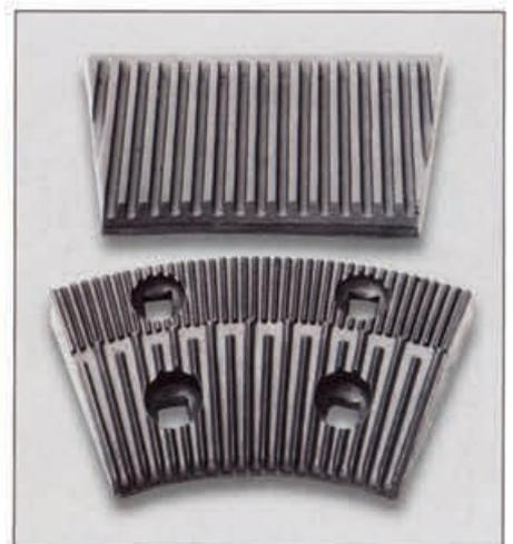
**Bild 15: Mahlscheibensegmente aus Cr-legiertem GJL-300, Stückgewicht: 10,6 kg**
