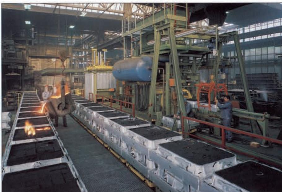
**Bild 8: Abgießen an einer hochmechanisierten und teilautomatisierten Formanlage**
