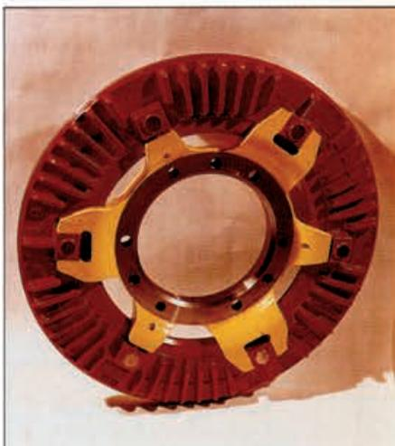
**Bild 101: Scheibenbremse Ø 680 mm für Schienenfahrzeuge; der Bremsring aus GJL-250 ist spannungsarm gegläht, die Paßflächen zur Nabe sind auf >48 HRC flammgehärtet**
