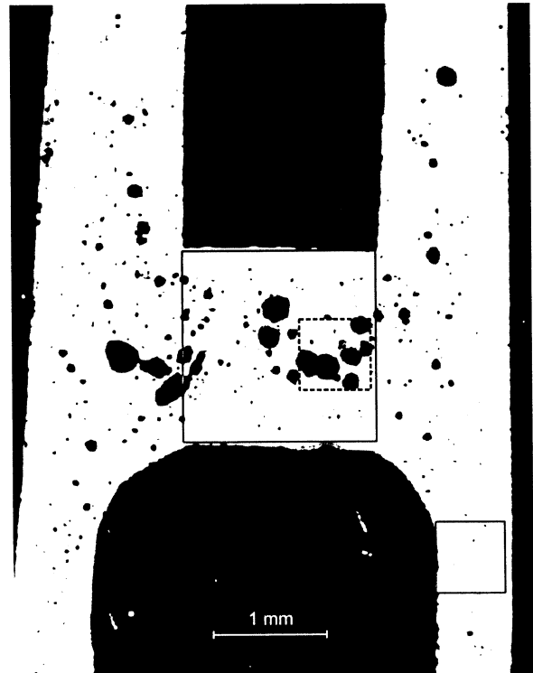
Porosität kleines Quadrat: 1 % Porosität großes Quadrat: 12 % Porosität gestricheltes Quadrat: ca. 30 %
